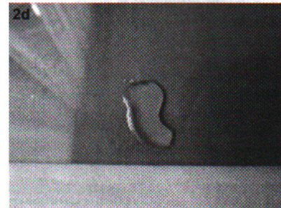
Obr. 2 - Tvar vodní kapky na povrchu materiálu ošetřeného technologií DFI. 2a - neošetřený povrch, 2b po nanesení první vrstvy, 2c po nanesení druhé vrstvy, 2d neošetřené sklo, 2e ošetřené sklo
